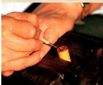
字入れ 彫刻文字の配置・配分をし、印面に直接、左文字を書く
