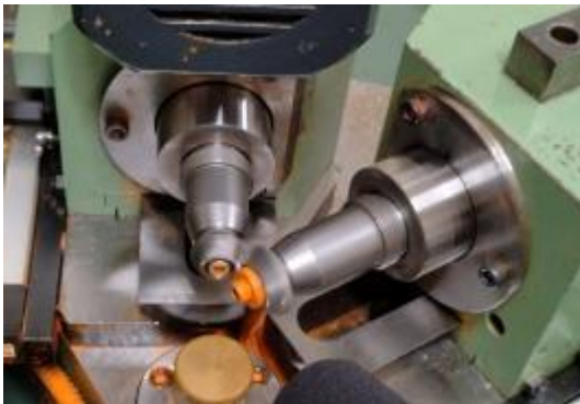
図 2-1 歯当たり試験の様子 (歯車に光明丹を塗布し、歯当たり試験機を用いてベベルギヤとピニオンギヤを噛み合わせた状態で一定時間回転させる)
