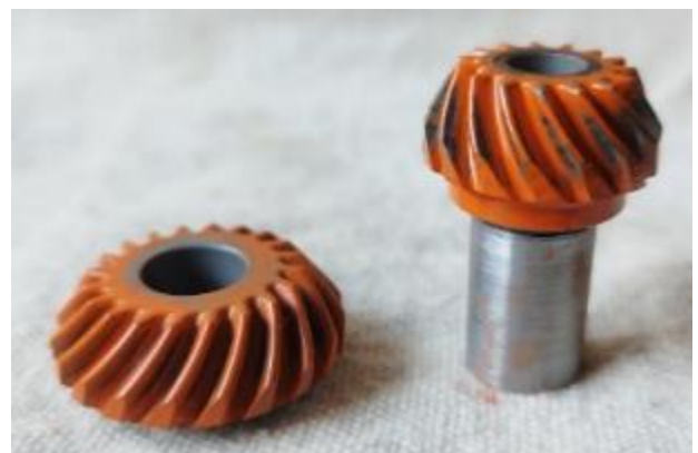
図2-19 かみ合い試験を行ったマスターギヤ
