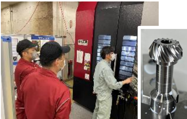
図2-18 マスターギヤ加工の様子
