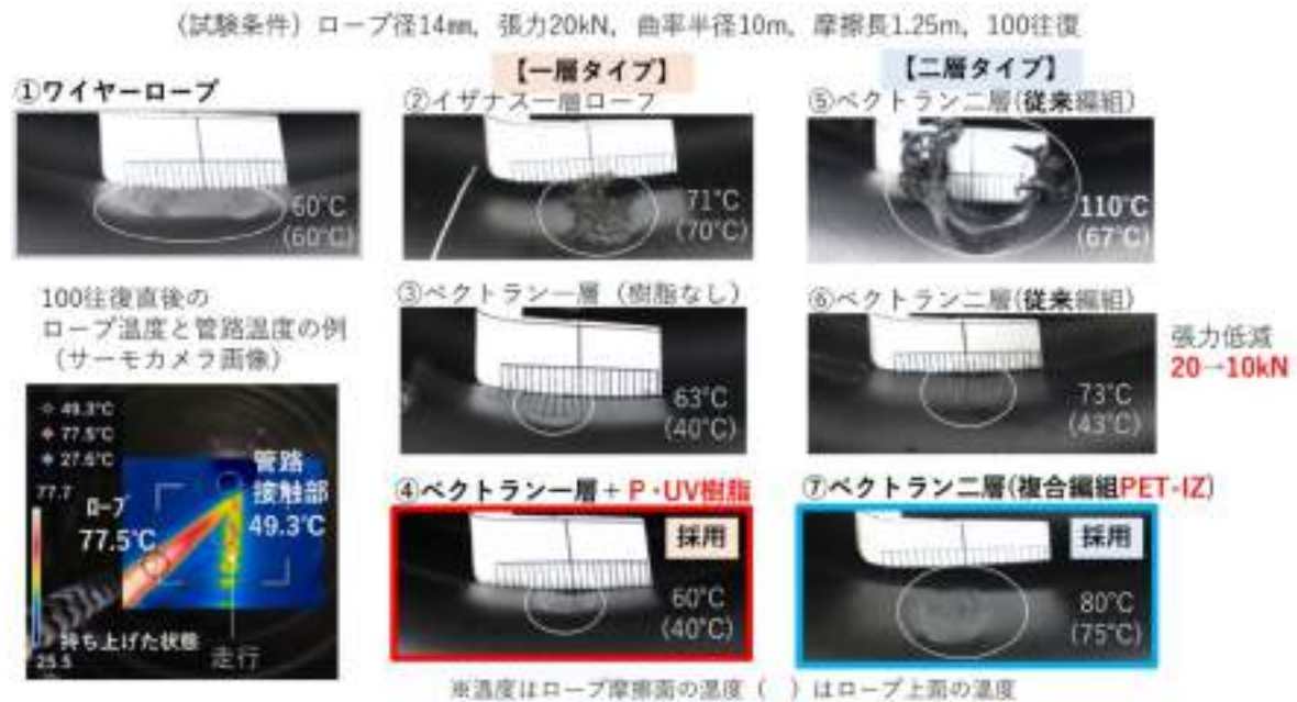
図 30 エフレックス管(硬質ポリエチレン管)摩耗試験状況
