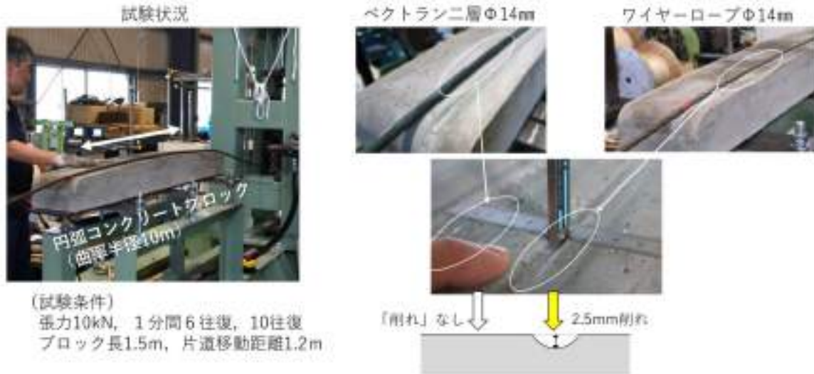
図 26 円弧コンクリートブロックの摩耗状況
