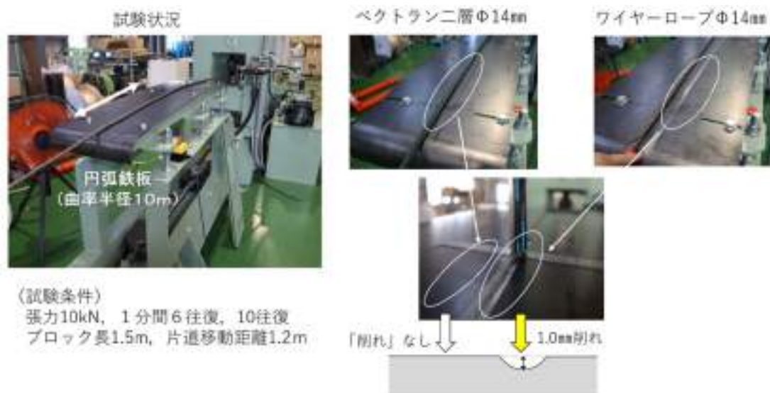
図 27 円弧鉄板の摩耗状況
