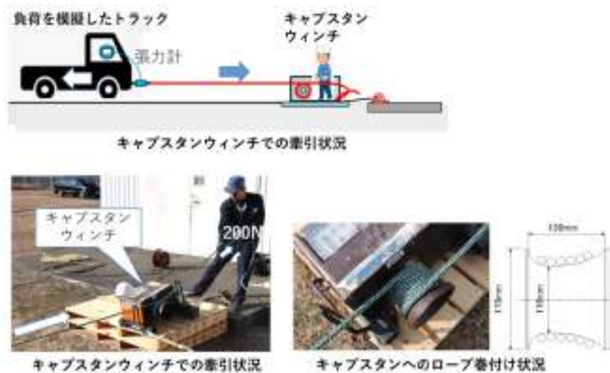
図 36 キャブスタンウィンチでのスティックスリップ確認試験状況
