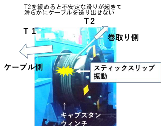
図31 ロープのスティックスリップ振動
