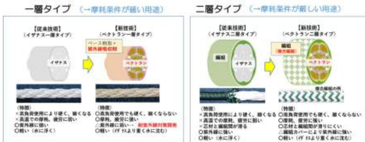
図11 「一層タイプ」及び「二層タイプ」の概要
