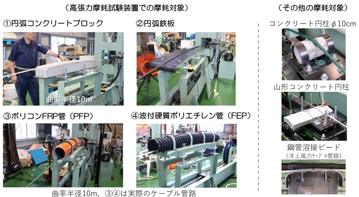
図 22 様々な摩耗対象による試験
