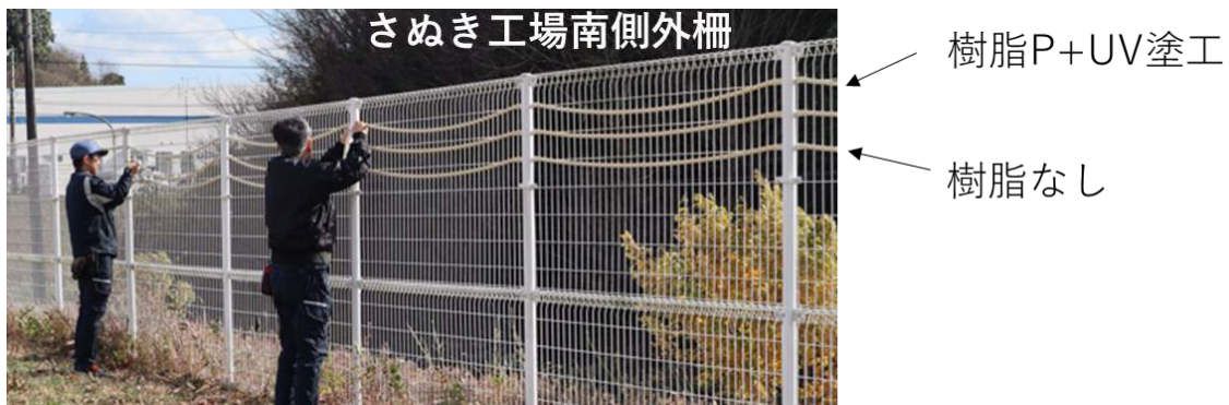
図20 ベクトラン「一層タイプ」φ14mmの屋外暴露試験状況
