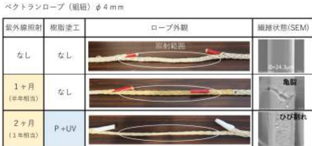
図 17 耐候試験前後の組紐の外観及びSEM観察結果
