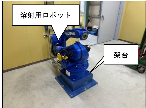
<溶射装置一式（溶射用ロボット及び架台）>
