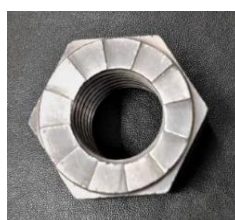
製作した傾斜段差付高力六角M36 ナットと段差形状
