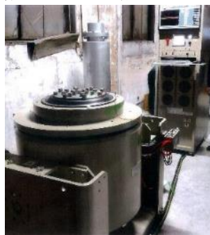
図22 月盛工業に導入したボルト振動試験機
