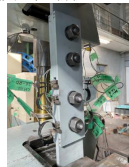
図 39 すべり耐力試験
