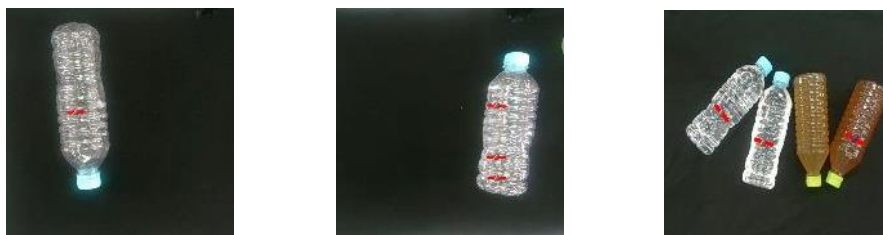
図 2-3-5 : 推論されたピッキング位置 (2本の赤のマーカ) 左から A、B、C
