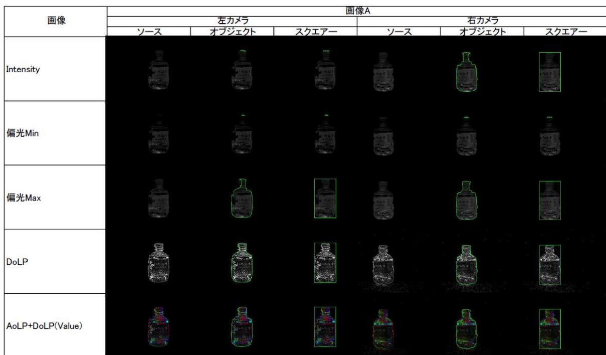
図 2-2-6 偏光カメラ画像撮像によるエッジ検出処理 (PET ボトル)
