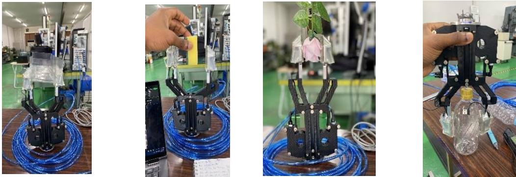
図 2-4-6：ハンドによる把持検証（ブリストアパック、スポンジ、バラの模型、ペットボトル）
