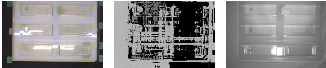
図 2-3-18 ブリスターパックの RGB 画像、深度画像、950nm 帯画像
