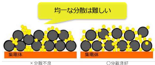
電極スラリーの材料分散イメージ
