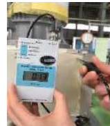
【運転状況検証イメージ】本体振動測定
