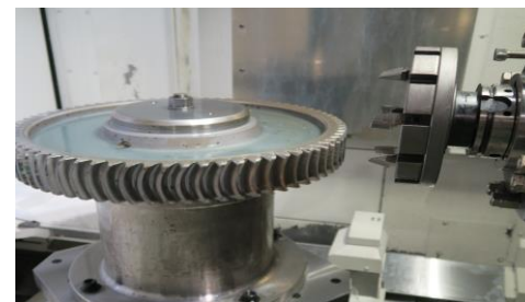
開発したツールによる円弧歯すじ歯車の加工風景
