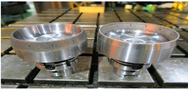
図19. 予備試作に用いられた仕上歯面研削CBN電着砥石
