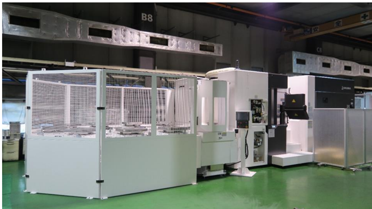
図25 小・大歯車(円弧歯すじ歯車)の仕上歯面研削の10面APC加工システム
