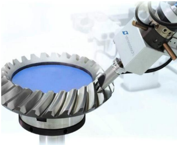
図30 バルクハウゼンノイズ法による研削焼け検査
