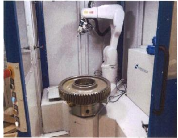
図31 導入したロボット式研削焼け自動検知装置
