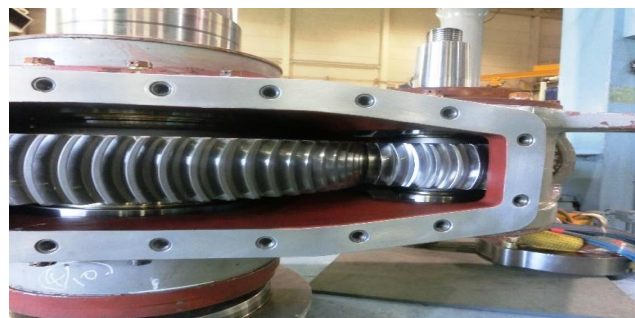
図6. イワサテック独自で試作・開発中の円弧歯すじ歯車
