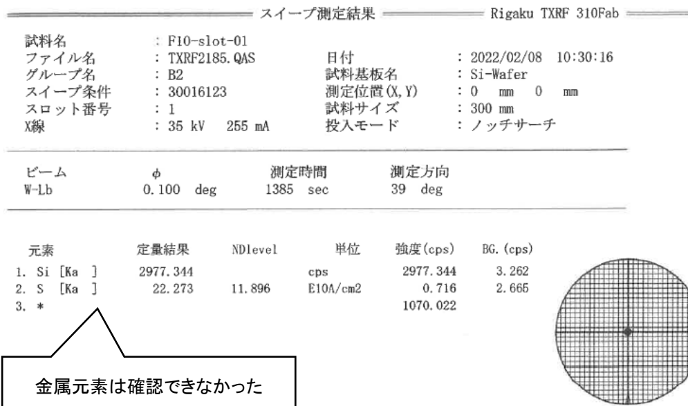
図 17 全反射蛍光 X 線分析装置の測定結果
