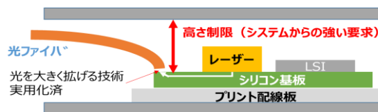
図3 シリコンフォトニクスと光ファイバの接続方式
