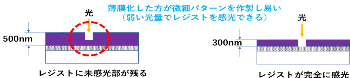
図 3 レジスト薄膜化のメリット 出典：(株)FSCE による作図
