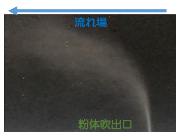
図 7 ナイロン6の粉体を使用する可視化実験
