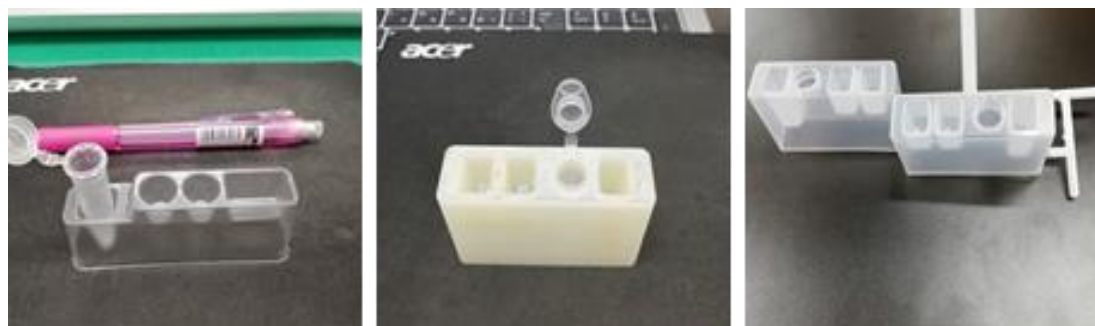
図 26. プリパックの真空成型品(左)、再検討品(中央)、射出成型品(右)
