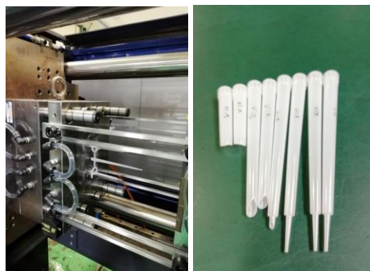
図 19. ピペットチップの金型(左)および成形品(右)
