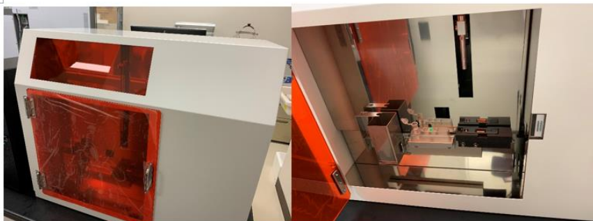
図 23. 自動ウイルス濃縮検出装置プロトタイプ1号機の外観（左）および内部（右）
