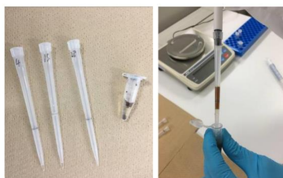
図 15. シリカモノリス搭載ピペットチップと糞便サンプル(左)およびそれらの通液試験(右)
