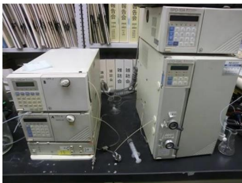
図 6. HPLC の装置(左)およびその結果(右)。縦軸が蛍光強度、横軸が保持時間を示す。ピークの保持時間でサンプルを集めることで均一の核酸を分取することが可能となる。赤四角の部分は目的の PNA プローブのピークを示す。
