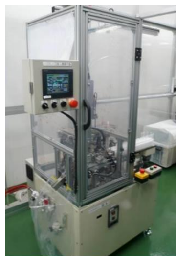
図 20. シリカモノリス自動挿入機
