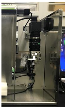
図 25. 自動ウイルス濃縮検出装置プロトタイプ2号機に組み込んだ検出部
