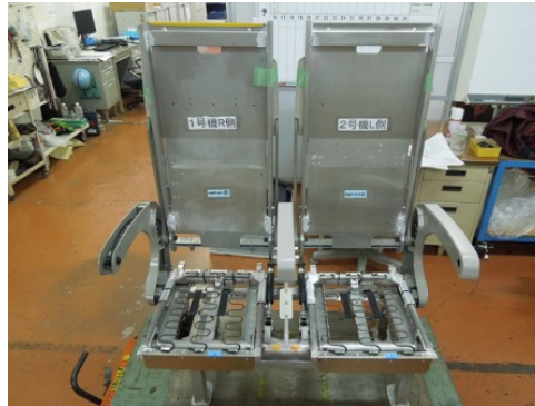
写真 2-2-11 オール新難燃性 Mg 合金製腰掛フレーム
