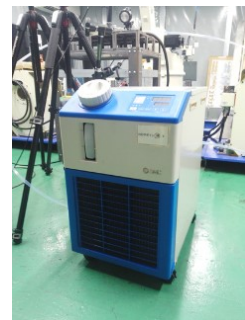
写真 2-2-17 治具冷却用サーモチラー
