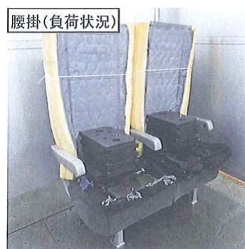
写真 2-3-4 座面荷重試験の状況
