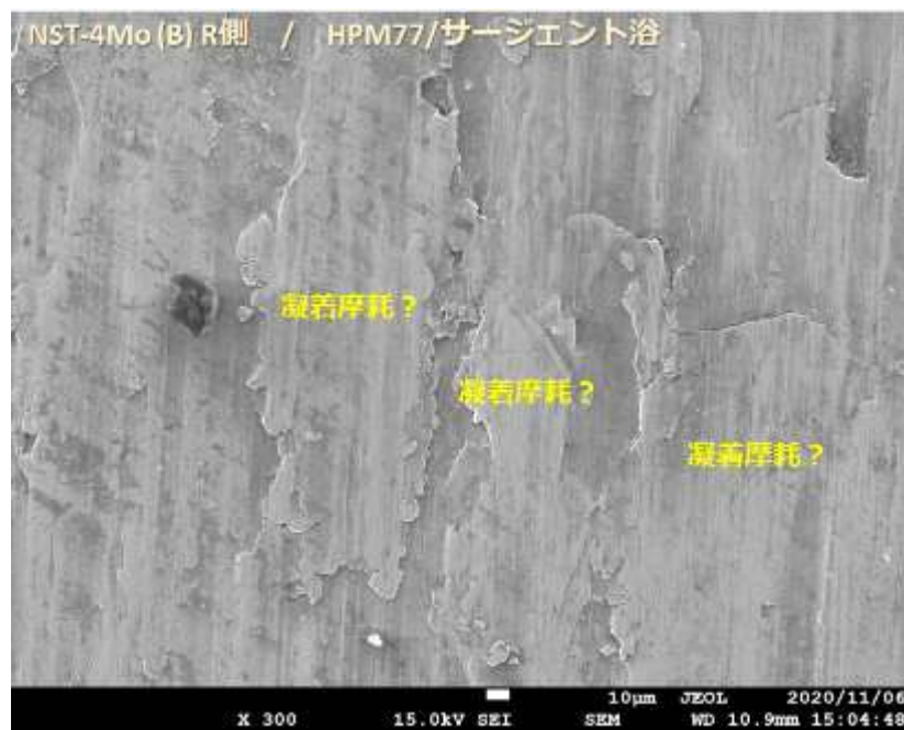
図2-2-6 NST-4Mo (B) R側 (HPM77/サージエント浴) の偏摩耗面のFE-SEM写真
