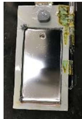
図2-2-9 めっき表面の状態（クラック状態はエッチング後に観察）
