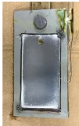
図2-2-9 めっき表面の状態（クラック状態はエッチング後に観察）
