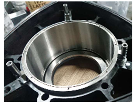
図2-1-3 ニードルベアリングロックガイドと固定用スプリングピン
