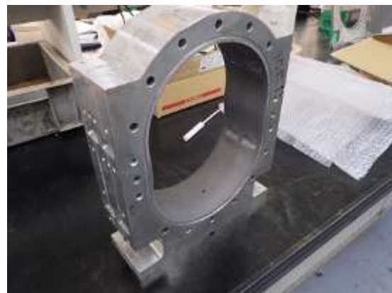
図 2-2-19 ハイブリッド型クロムめっきを施したハウジング
