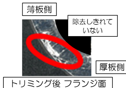
図2. 28 不具合部の残存（フランジ面写真）
