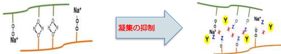
図9 CWSolid 法Ⅲ型による CNF の凝集抑制モデル
