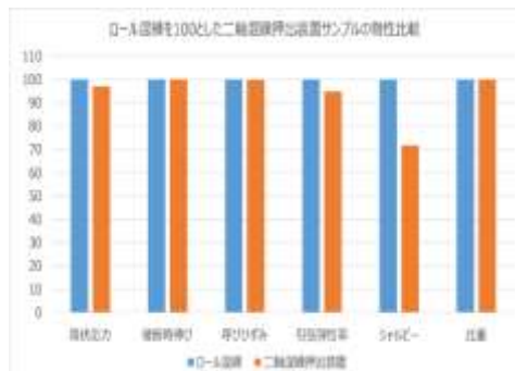
図2-2-14 ロール混練と二軸混練の物性
