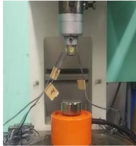
図2-20 圧縮型高精度荷重計とひずみゲージによる測定
