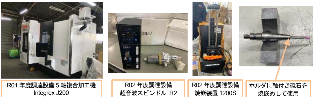
図2-1 US+HS 研削に使用する工作機械と超音波スピンドル
