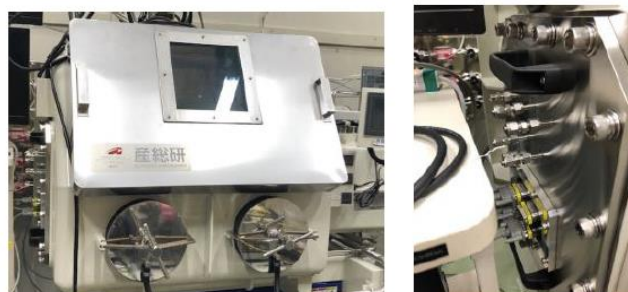
図4-1-4 真空封じ型グローブボックス外観 (左) 正面写真、(右) 粉末導入部
