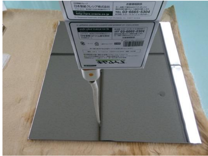
図 I 電解砥粒研磨した大型(150 x 150 mm) ステンレス基板
