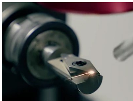
レーザーで加工中のNPD特殊工具
