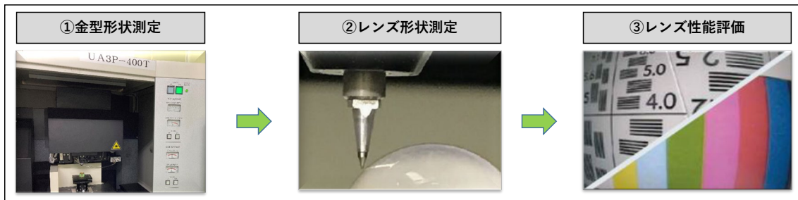
図 15 レンズおよびレンズ金型の評価の流れ
