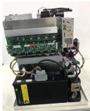
(b) 実装した制御基板
