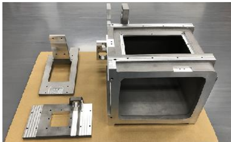
図 15 切削加工後のアルミ躯体
