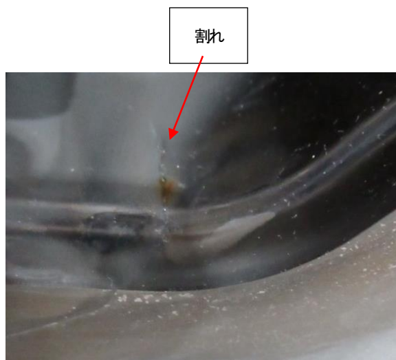
図4 ライン冷却近傍の割れ
