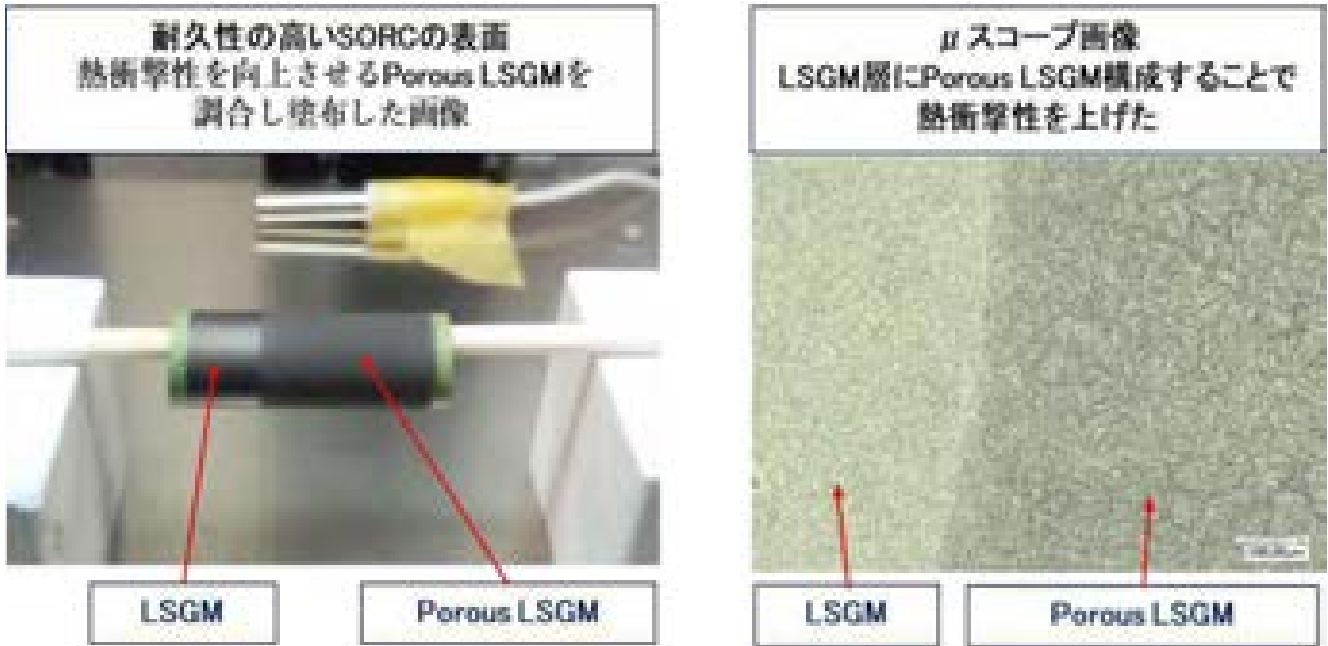
図 10 円筒型 SORC の試作結果と断面評価結果
