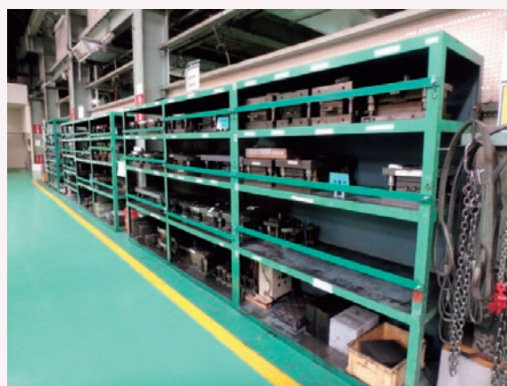
落下防止装置を施した金型置き場
