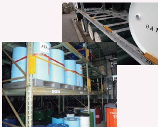
2011年3月7日に設置が完了し、震災による被害を防いだ耐震ラック
