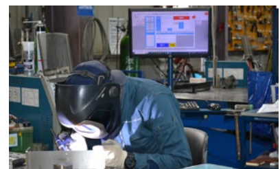
「TED」で図面や作業進捗を確認しながら、溶接作業を進める
