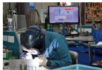
「TED」で図面や作業進捗を確認しながら、溶接作業を進める
