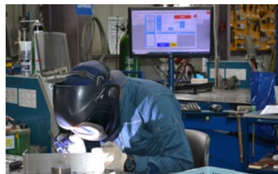
「TED」で図面や作業進捗を確認しながら、溶接作業を進める
