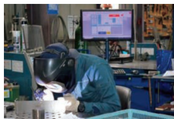
「TED」で図面や作業進捗を確認しながら、溶接作業を進める
