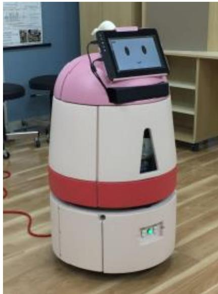
全面が接触検知カバーのロボット
