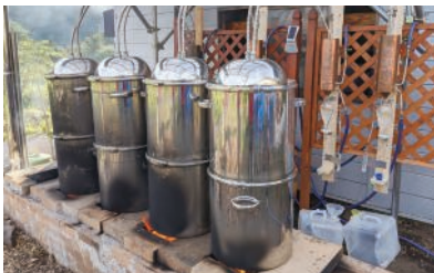
アロマオイルを精製する蒸留釜
