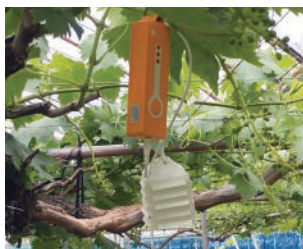
センサーで計測した気温、湿度などのデータをクラウドに保存
