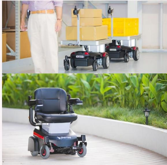
運搬型ロボット「サウザー」(写真上) と搭乗型ロボット「ガルー」(写真下)
