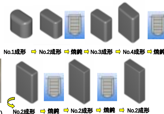
試作した電池ケース(右端が完成品)
