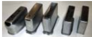
試作した電池ケース(右端が完成品)
