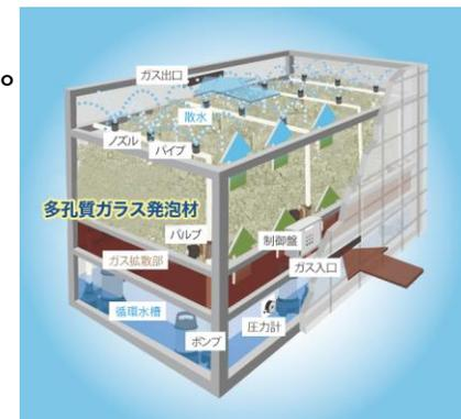
脱臭装置の仕組み
