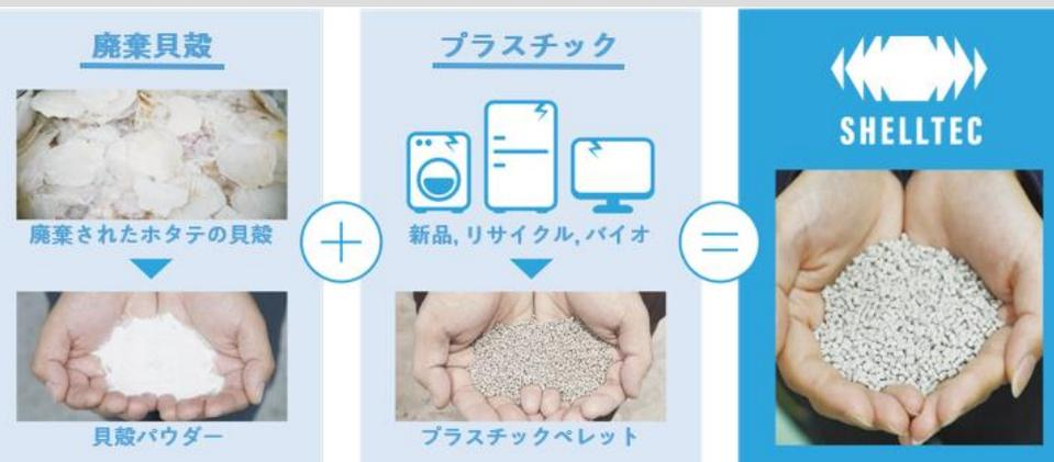
プラスチック加工が得意な家業の強みをいかし、廃棄貝殻を粉砕し、プラスチックに混ぜて、強度も強く、
