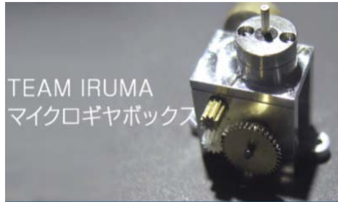
チーム入間共同製作（設計～試作完成 1ヶ月） 1辺6mm程のボックスを100分の1ミリ単位で 製造された30点の部品で製造
