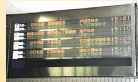
LED(発光ダイオード)を使って、工場の進捗管理システムを開発し、生産性をアップ。駅などの運行案内に使用される小型LED(発光ダイオード)表示器は、一般的な256色表示から表示可能な色を約10億色まで増やすことに我が国で初めて成功。また1秒間に一般的には10コマの切り替えを100コマの切り替えまで可能にしました。現在、農業分野にもLEDを応用した開発(例:植物育成用LED光源、最適な栽培条件を見つけるためのチャンバー等)を進めております。
