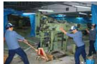
FCH(綿状の羊毛を段階的に細く引き伸ばしていく設備)を切断し、適度な大きさにしている様子
