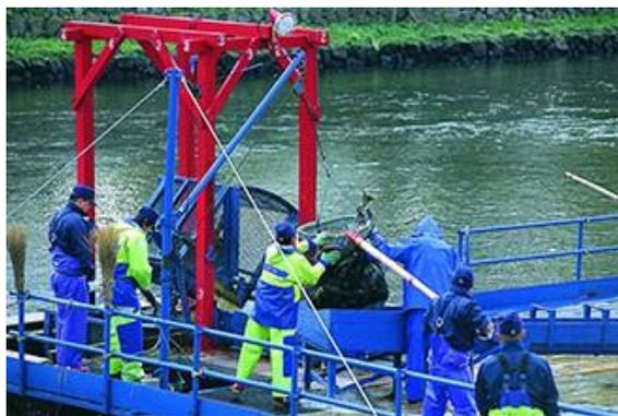
図表 17 溯上するさけを捕獲する捕魚車（インディアン水車）
