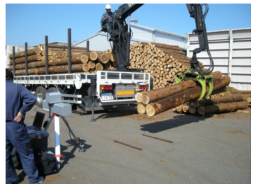
<ポータブル三次元画像解析材積測定器と測定風景>
