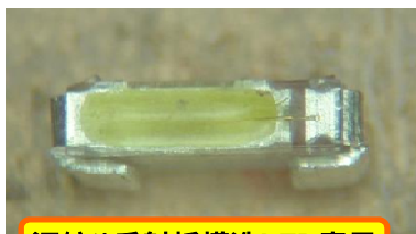
深絞り反射板構造LED素子
