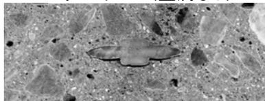
温度応力試験(ひび割れ誘発)
