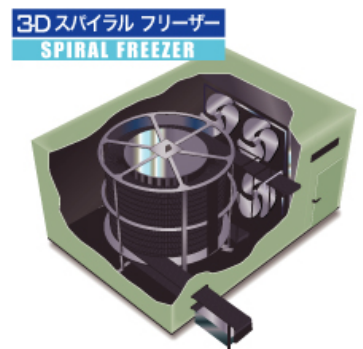
自社開発した大型冷凍システム (スパイラルタイプ)
