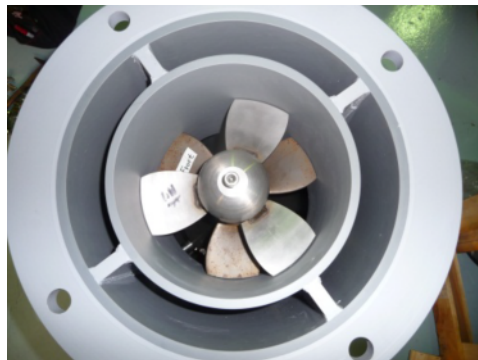
水力発電機 (上から)
