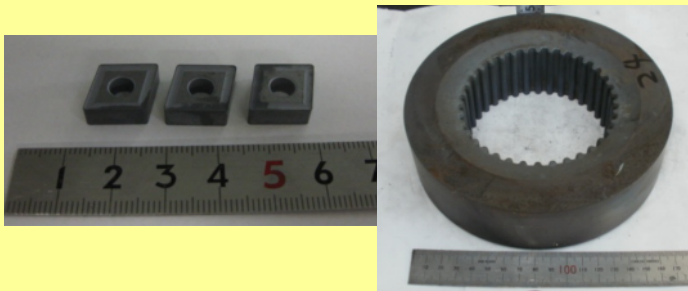
使用済みの超硬合金 (左: 切削工具 右: 耐摩耗工具)
