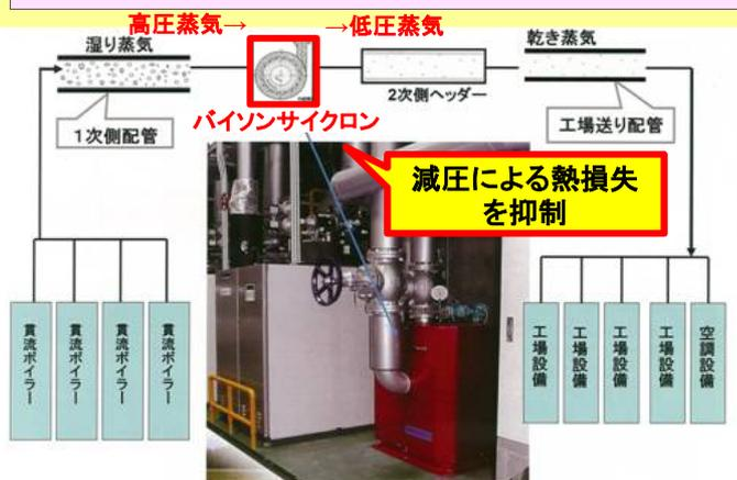
ボイラー蒸気圧力調節器の構造
