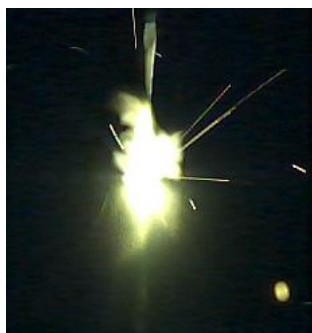
溶接時のプラズマ発生状況
