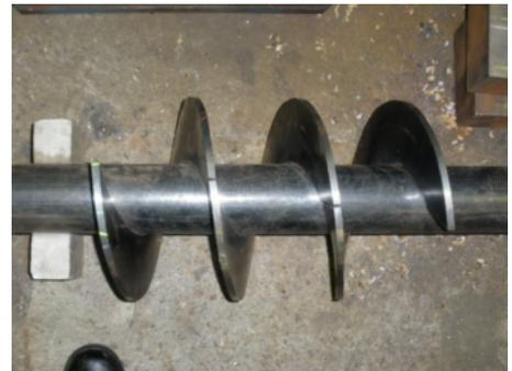
羽根曲げ成形機で製作したスクリー羽根
